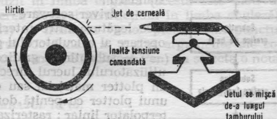
Fig. 3.9. Principiul plotterului cu jet de cerneală („ink-jet“).
