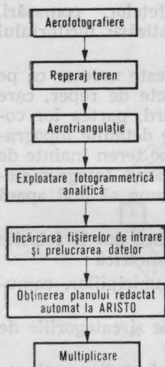
Fig. 10.16. Schema fluxului tehnologic de obținere a planului cadastral digital.
